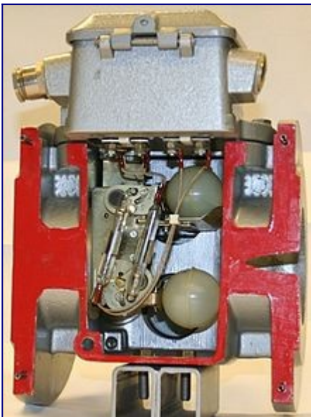
Photo d'un relais Buchholz où on voit distinctement les flotteurs
