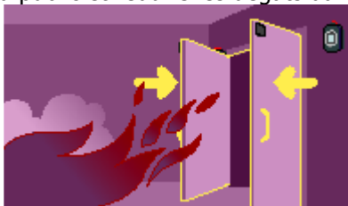
Fermeture des portes coupe-feu grâce aux ventouses électromagnétiques
