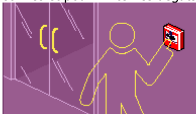
Appui sur le déclencheur manuel
