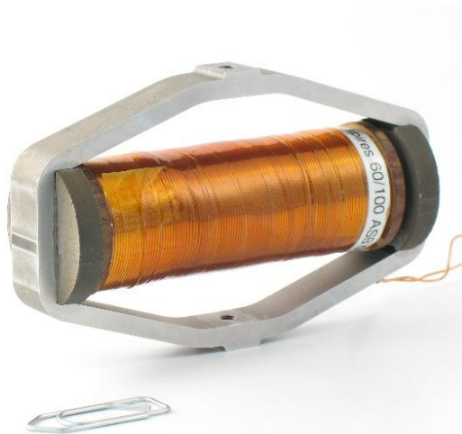
(a) Actionneur magnétostrictif avec système d'amplification mécanique, conçu pour produire de grands efforts (>20kN) et de grandes courses (>200 \mu m) à basse tension (<12V) en statique comme en dynamique.
