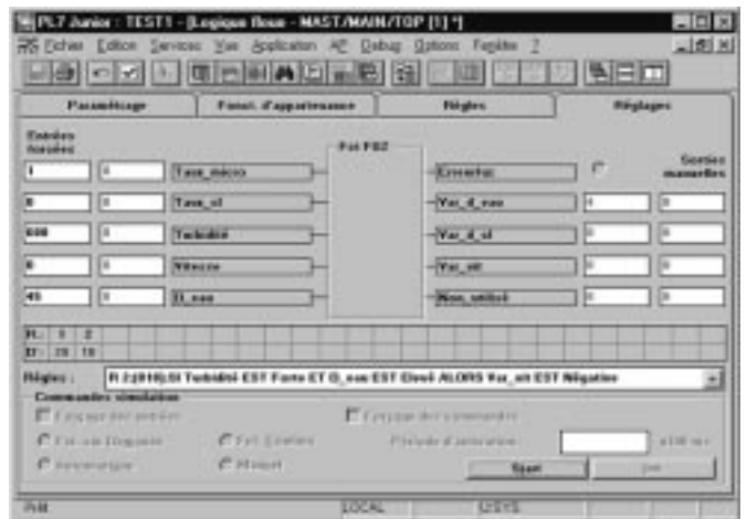
Fig. 30 : pour la logique floue, les automates Schneider disposent d'outils de développement conviviaux sur PC.
